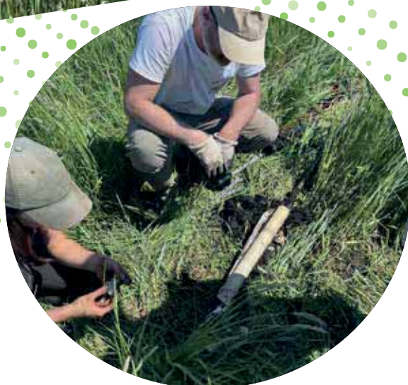
Mise en place de piézomètres pour mesurer les niveaux d'eau
